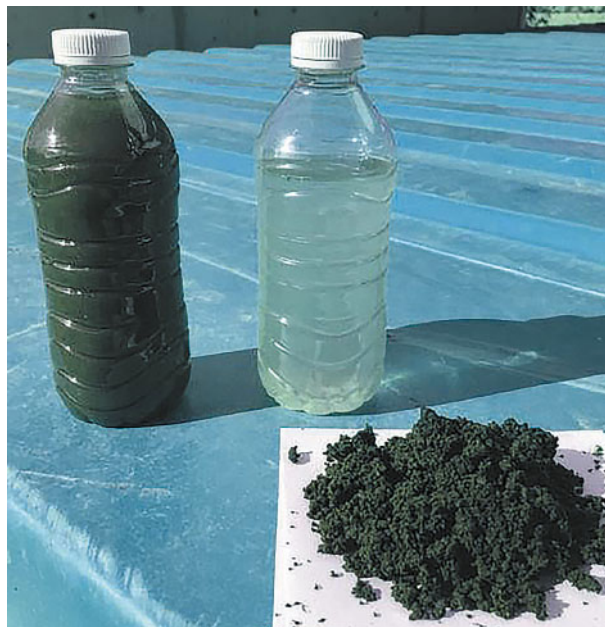
Слева: осадок перед обезвоживанием Справа: фугат и обезвоженный осадок
