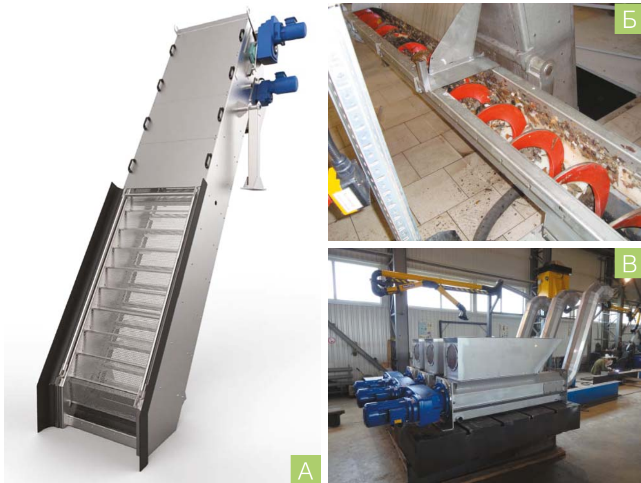
Рис. 1. Процеживающее оборудование А – ПЕРФОРИРОВАННАЯ РЕШЕТКА, Б – ТРАНСПОРТЕР ОТБРОСОВ, В – ПРЕСС-УПЛОТНИТЕЛЬ ОТБРОСОВ (ВИНТОВОЙ)
