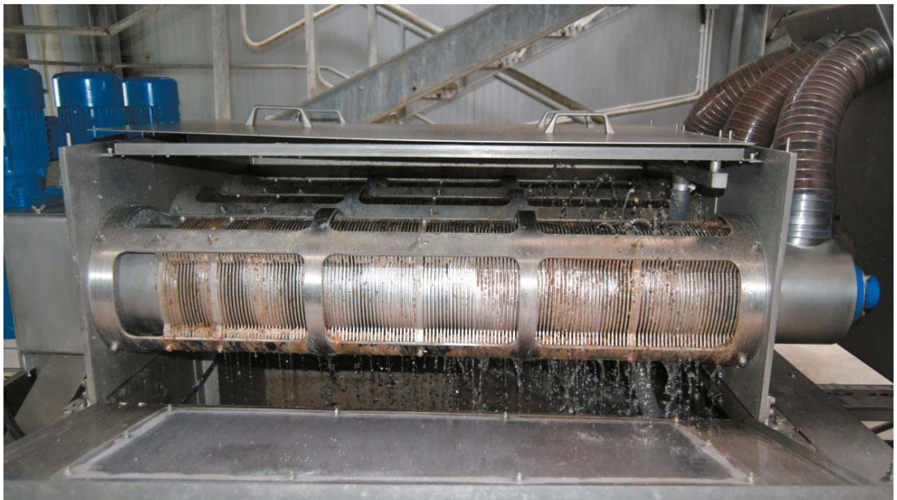
Рис. 5. Промывка обезвоживающего барабана мультидискового шнекового дегидратора
