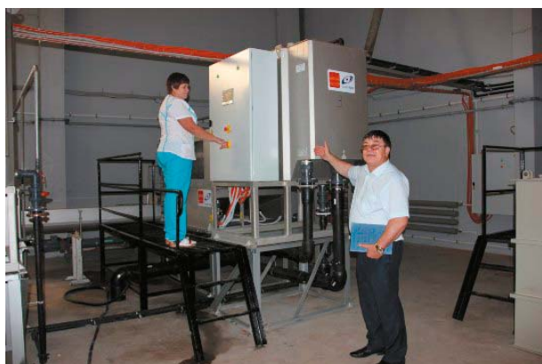
Рис. 2. Мультидисковый шнековый дегидратор MDQ-352 С (Горно-Алтайск, Россия)
