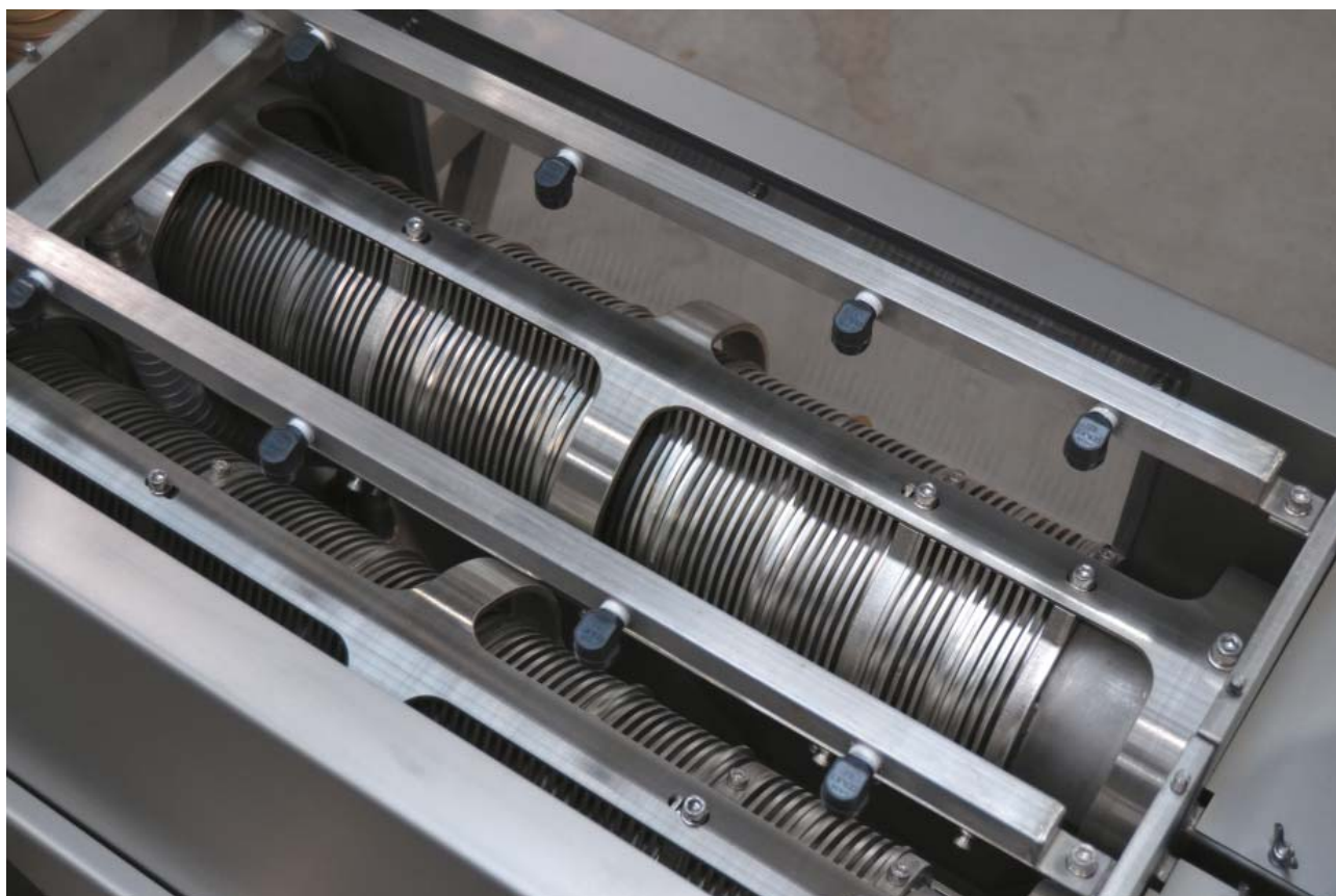
Рис. 6. Обезвоживающие барабаны мультидискового шнекового дегидратора
